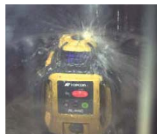
防塵試驗(保護等級6級) 防水試驗(保護等級6級) 不受 75\mu\text{m} (0.075mm)的粉塵侵入 能抵擋全方向強力的噴射水流
