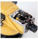
性與準確度。既使儀器位於重機械附近 或者忙碌的道路旁所產生的細微震動環 境中,磁性阻尼微調系統也能夠快速的 水平以及穩定視準線。
